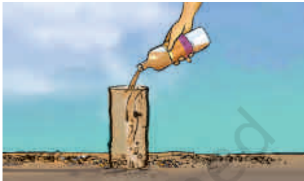
चित्र 9.5 अंतःस्त्रवण दर को मापना
